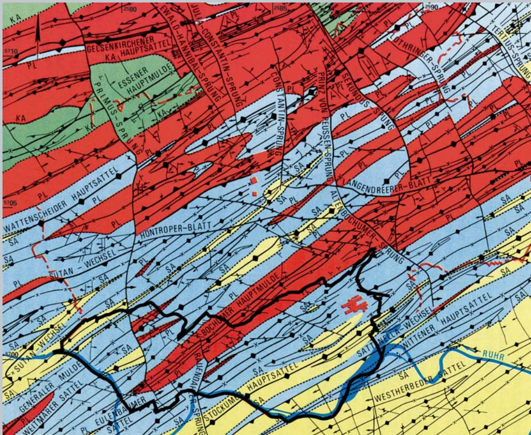
Abb. 3: Horizontalschnitt durch das Steinkohlengebirge im Stadtgebiet Bochum auf dem Niveau 500 m u. NHN (verändert nach BADER & RÖTTGER 1987: 17)
