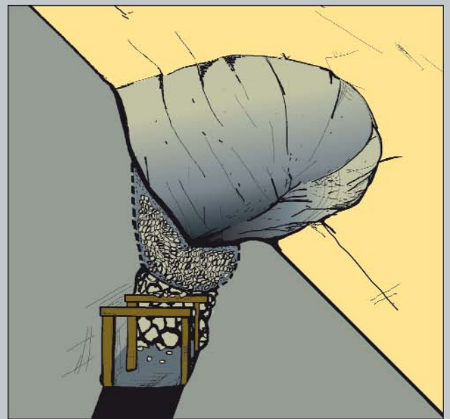
Tagesbruch im Spätstadium (konsolidiert; in Anlehnung an SINGH & DHAR 1997: 334; van den EECKHAUT et al. 2007: 31)
