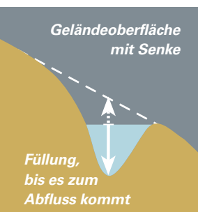
Abb. 35: Bei starker Geländeneigung wird die Senke nicht bis zum oberen Rand gefüllt. Dies kann zu geringen Abweichungen bei der Berechnung der Fläche und Tiefe mit der Füllmethode und anschließender Differenzrasterbildung führen (verändert nach SCHÄUBLE 2003: 13).
